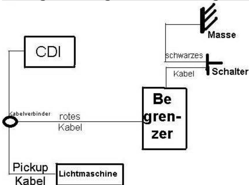
Das rote Kabel des Begrenzers muß in die Signal führende Leitung zwischen Lichtmaschine und CDI eingeschleift werden, das sog. Pickupkabel. Dazu bitte beiliegenden Kabelverbinder verwenden. Das schwarze Kabel bitte sorgfältig mit der Fahrzeugmasse verbinden (NICHT den Minuspol der Batterie!). Wenn nötig den Rahmen etwas anschleifen und vom Lack befreien. Bitte darauf achten, daß wirklich Kontakt zur Masse besteht und keine Kunststoffteile dazwischen sind.
