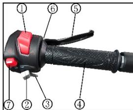
matrícula; marque en la posición "I", las luces delanteras, las luces traseras y las luces de matrícula se encienden; marque en la posición más a la derecha, las luces se apagan, a menudo se usan durante el día.
