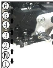
que la punta del pie levanta la palanca de cambios, pasa a la siguiente pendiente alta; cada paso en la punta del pie se mueve a la siguiente marcha baja.
