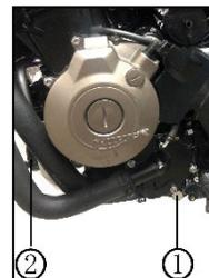
1. Use el filtro de aceite para quitar la herramienta especial para atascar el filtro de aceite, gírelo en sentido antihorario y retire el filtro de aceite que necesita ser reemplazado.
