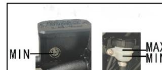
El nivel de líquido se reduce porque el líquido almacenado en el cilindro se inyecta automáticamente en la manguera del freno después de que se desgasta el disco de fricción. El depósito de líquido de frenos delantero está instalado sobre la manija derecha del vehículo, y si el nivel de líquido está por debajo de la línea de calibración del límite inferior del depósito de líquido o la marca de límite
